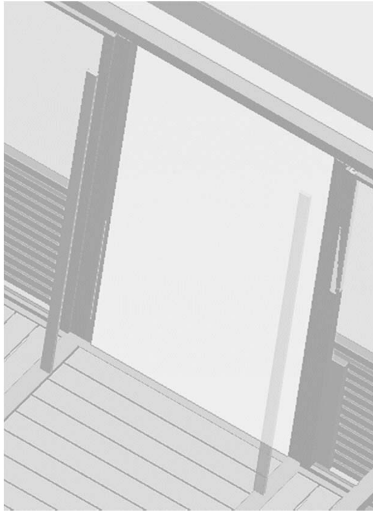
KUVA 18. Asenna oven pieliin 15x45 rimat 4.5x55 ruuveilla neljällä molemmat
