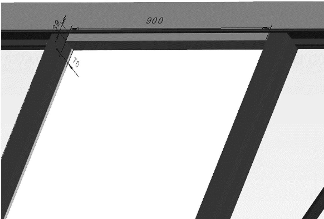
KUVA 24. Laita oviaukkoon 39x70x900 puu kolmella 5x70 ruuvilla
